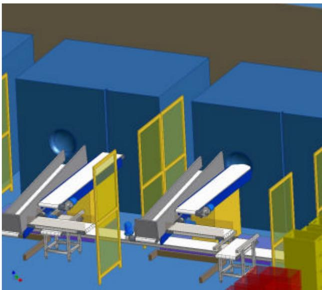
Este equipamento prevê: descarregar automaticamente as solas depois que estiverem lavadas, virar as caixas, empilhar as caixas cheias. As solas são transportadas automaticamente na direção de um único ponto de recolhimento. Aqui as solas são viradas automaticamente numa cesta até enchê-la.
